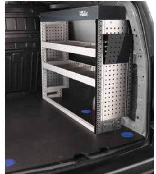
\*Les armoires doivent être montées sur un plancher en bois 12 mm.
